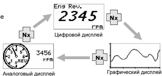
На аналоговом дисплее отображается до 2-х параметров. При выборе 3-х, будут отображаться только 2 первых.
